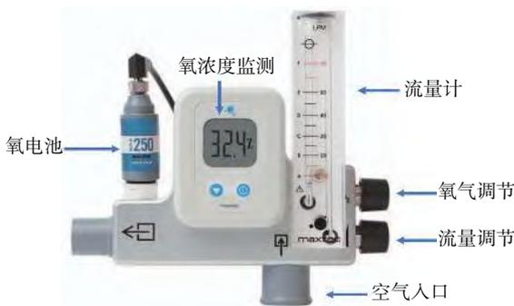
图11 Max-Venturi 装置
